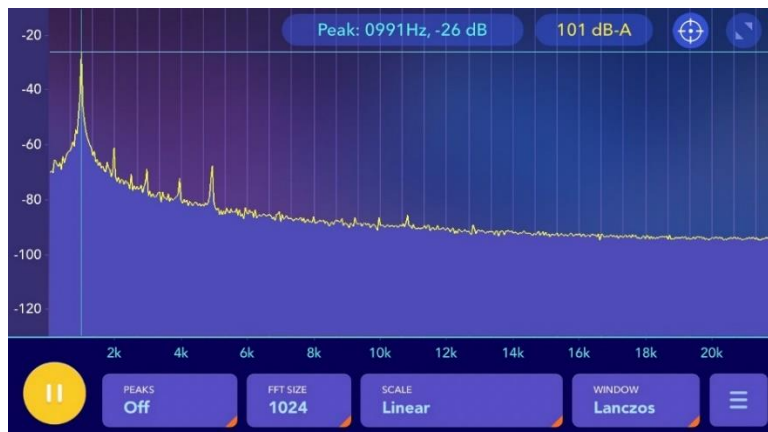
圖七、「Spectrum App iOS」軟體內截圖。除第一波峰為基頻，其他波峰皆為泛音的頻率。
