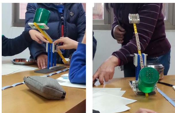
<圖七> 調整抗力臂施力臂比例投射
