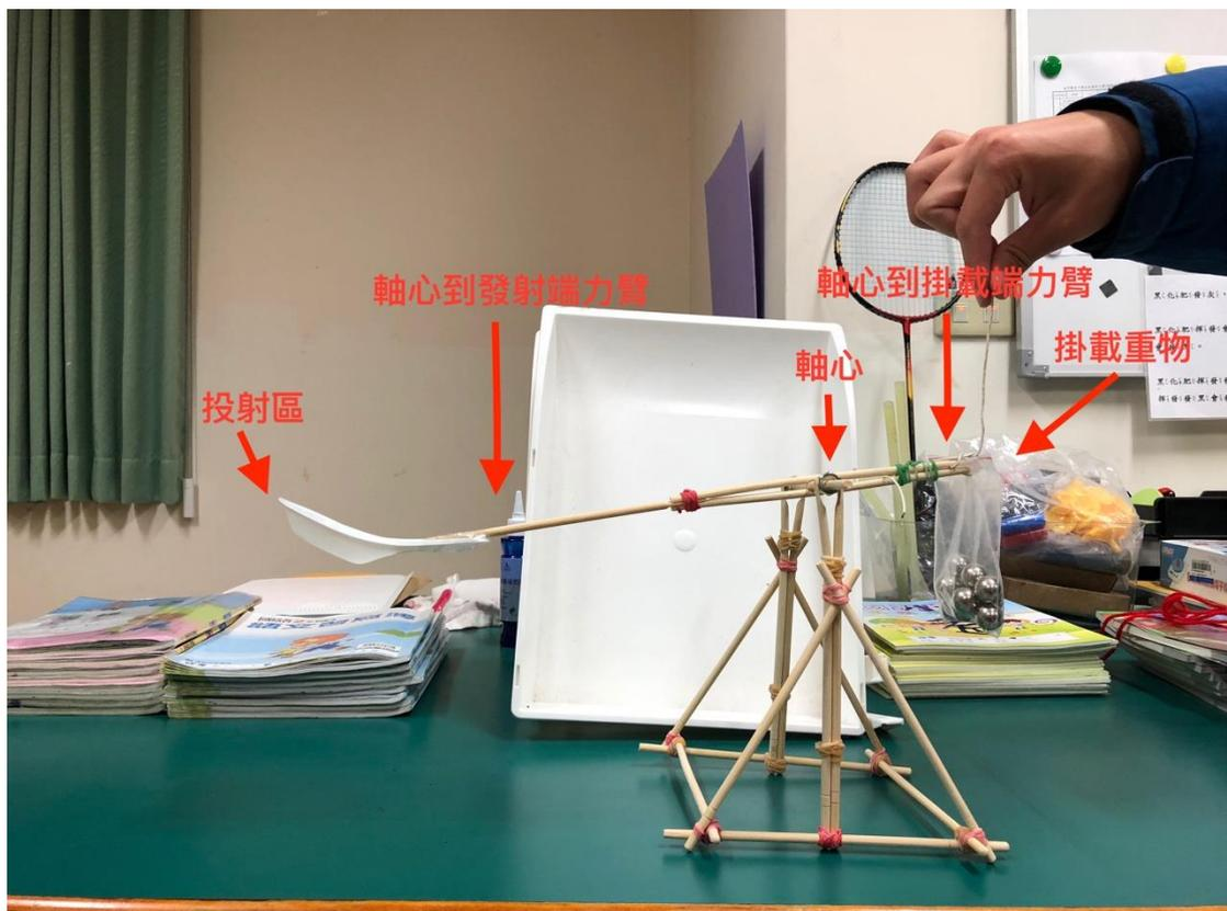
經由我們上網 Google 之後，發現投石車可以分成我們圖片之中說明的幾個部分包括：投射區、軸心到發射端力臂、軸心、軸心到掛載端力臂、掛載重物。我們發現對於一台投石車來說，決定石頭可以丟多遠的因素是由掛載重物的重量跟投射物的重量來決定。所以我們決定每次都修改掛載物的重量看看會有什麼不同的結果。經由我們的實驗，發現掛的重物重量愈重，投出的距離會愈遠。
