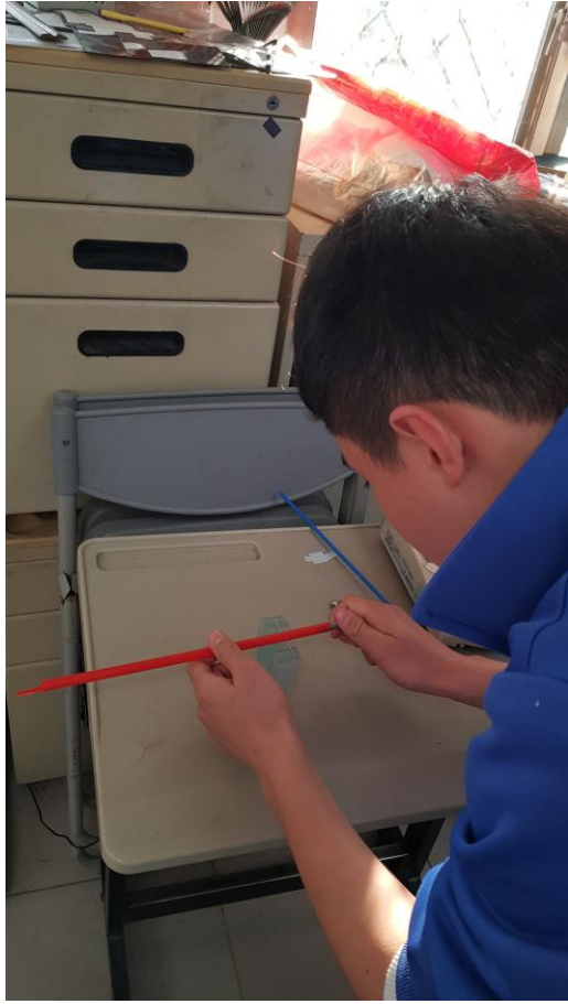
製作麥管天平需找尋重心，調整校準螺絲
