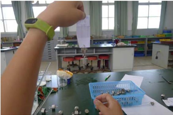
5.在測試物品的下方穿一個洞，掛上砝碼，如果未滑動則再增加砝碼數量，直到滑動為止。
