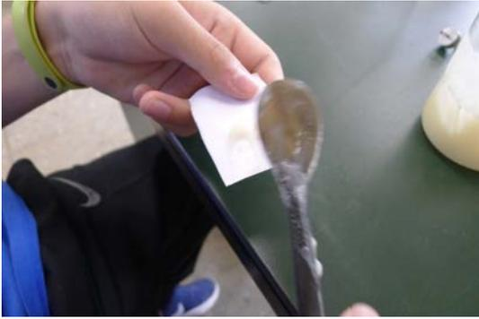
3.隔水加熱 90 秒，攪拌成麵糊後，用小湯匙舀一平匙，均勻的塗抹在要測試的物品上。
