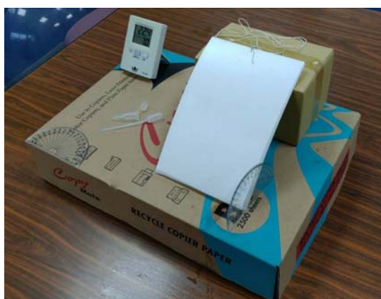
圖五、盆栽用 PP 板與水珠間靜摩擦係數 \mu_s 之測量裝置圖
