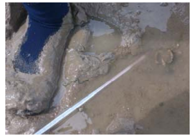
圖七、將溫度計平放於水中量測水溫
