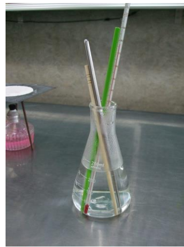
圖1.2 加熱後溫度上升到 77 度
